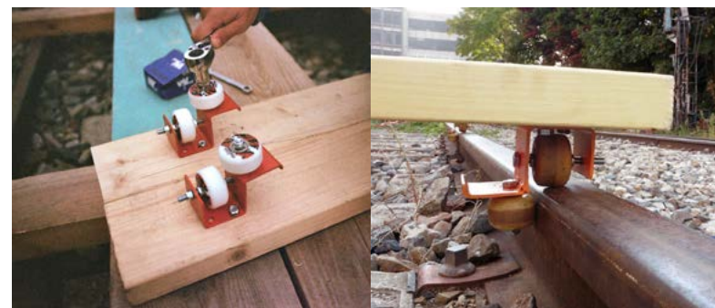
Le système « ZIP », réalisé avec des roues de skateboard récupérées.
